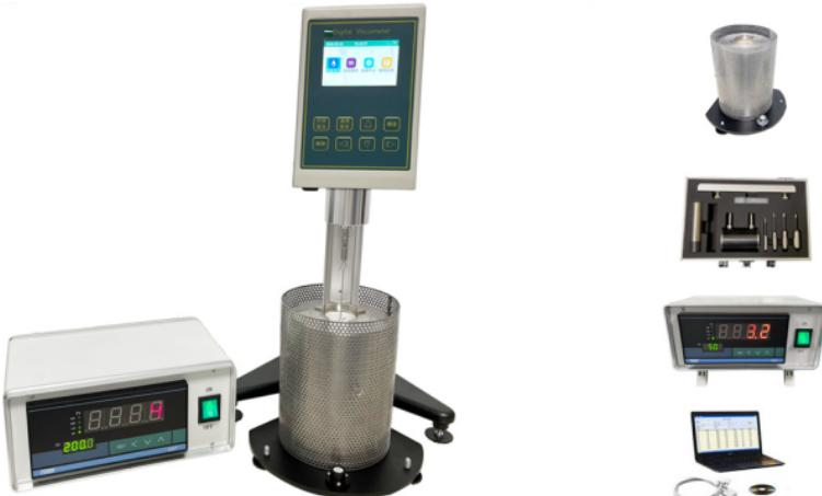
\* 注：0号转子为选配件,可测低粘度0.1mPa.s。专用于测量低粘度的样品,样品量仅需25ml;圆柱体转子可以准确计算剪切率;便于详细分析产品。
